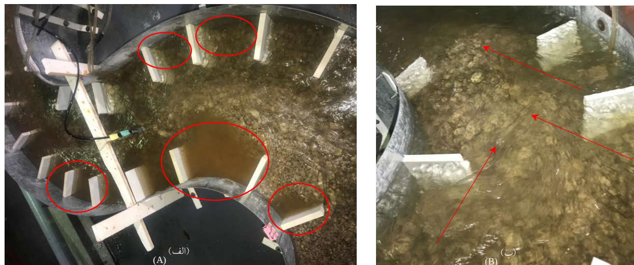
شکل ۹- نمایی از تغییرات الگوی جریان در اطراف سرریزهای قوس رودخانه الف) مجموعه آزمایش‌های W_{S1-1} ، ب) مجموعه آزمایش‌های W_{S3-3} . Figure 9. A view of the flow pattern around the bendway weirs a) test set W_{S1-1} , B) test set W_{S3-3} .
