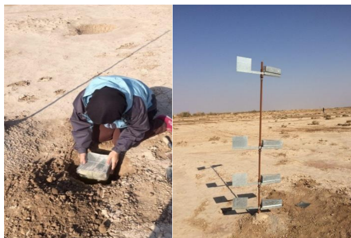
شکل ۱- نصب نمونه‌گیرهای BSNE و تله‌های خزشی.
