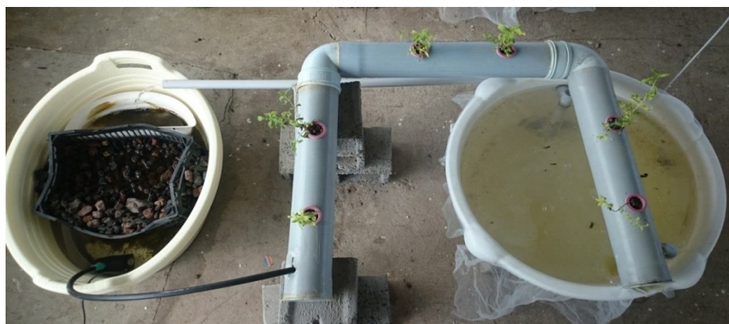
شکل ۲- نمایی از سیستم نوار غذایی.
