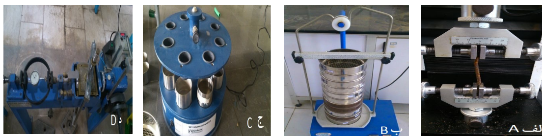
شکل ۴- مقاومت کششی ریشه توسط اینسترون (الف)، منحنی دانه‌بندی توسط شیکر الک به روش خشک (ب)، پایداری خاکدانه به روش تر (ج)، مقاومت برشی خاک، زاویه اصطکاک داخلی خاک و چسبندگی خاک توسط دستگاه برش مستقیم (د).
