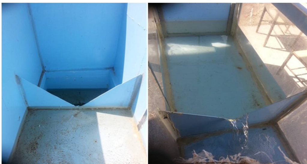
شکل ۶- سرریز ورودی مثلثی با رأس ۹۰ درجه، در ابتدا فلوم.
