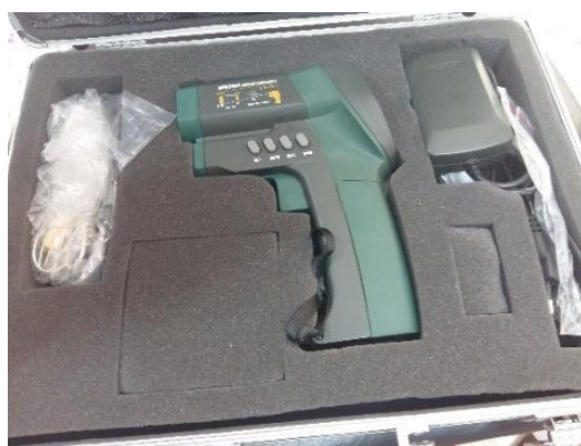
شکل ۳- دماسنج لیزری استفاده‌شده برای ثبت دمای آتش تجویزی.
