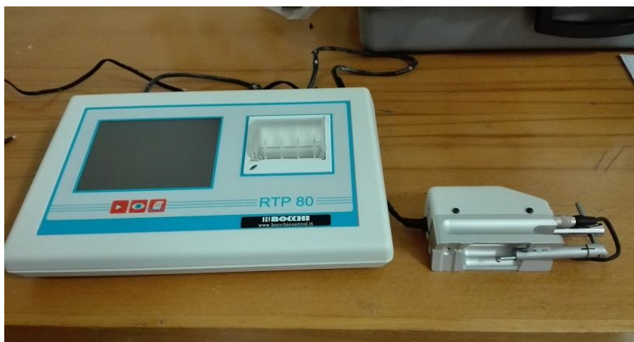
شکل ۱- دستگاه پروفیلومتر پرتابل سوزنی. Figure 1. Portable stylus profilometer device.
