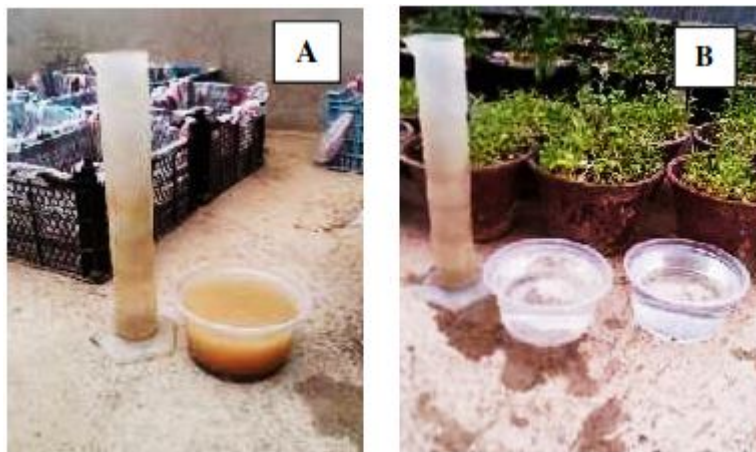
شکل ۵- نمونه‌ای از رواناب خروجی از انتهای جویچه معمولی (الف) و نمونه‌ای از رواناب خروجی از انتهای نیم‌لوله سوراخدار (ب).
