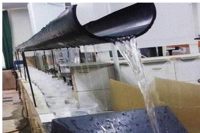
شکل ۱- نمایی از نیم‌لوله سوراخ‌دار استفاده شده در آزمایشگاه.
