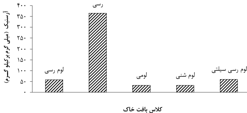
شکل ۳- میانگین آرسنیک خاک (میلی‌گرم بر کیلوگرم) برای کلاس‌های مختلف بافت خاک (USDA، ۱۹۹۳).
