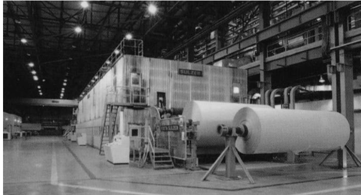
شکل ۳- واحد ماشین کاغذ شماره ۲ (محصول: کاغذ مقوای کنگره‌ای فلوتینگ).
